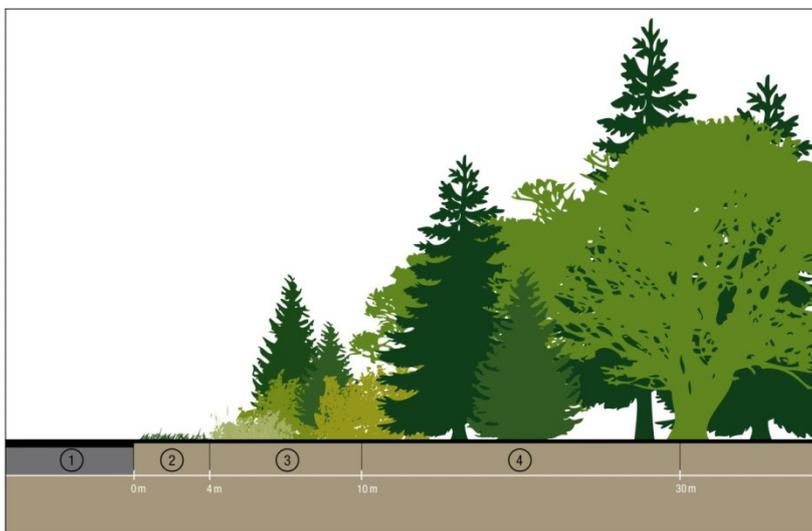
Abb. 3: Aufbau eines idealtypischen gestuften Waldrandes. 1: Fahrbahn; 2: Intensive Unterhaltszone; 3: Zone der Sicherheitsholzerei bis 10 m; 4: Zone der Sicherheitsholzerei von 10 – 30 m.
